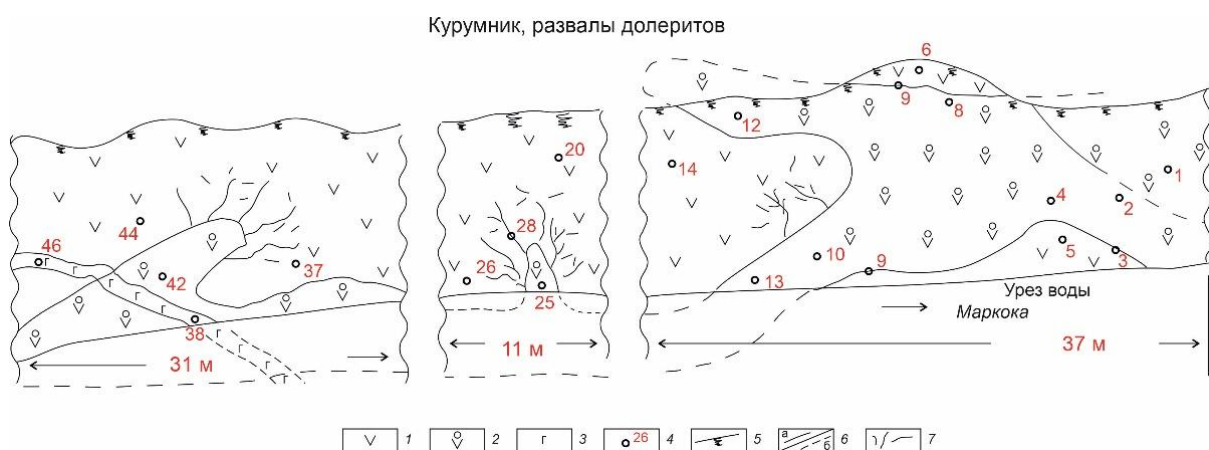
Рисунок 2 – Схематический рисунок обнажения Мр-61. Общая протяженность обнажения ~ 900 м, высота коренных выходов 8-10 м.
