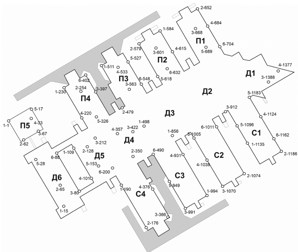
Рисунок 2 – Схема расположения термометрических скважин под зданием центра охраны материнства и детства «РБ№1-НЦМ»
