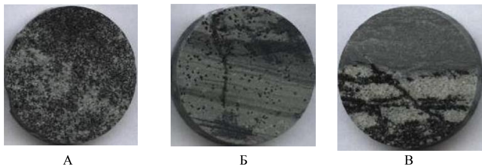
Рис. 1. Распределение рудной минерализации: а, б) – по слоистости и в пересекающих её прожилках; в) мелкая вкрапленность в метасоматите, аншлифы, натуральная величина.
