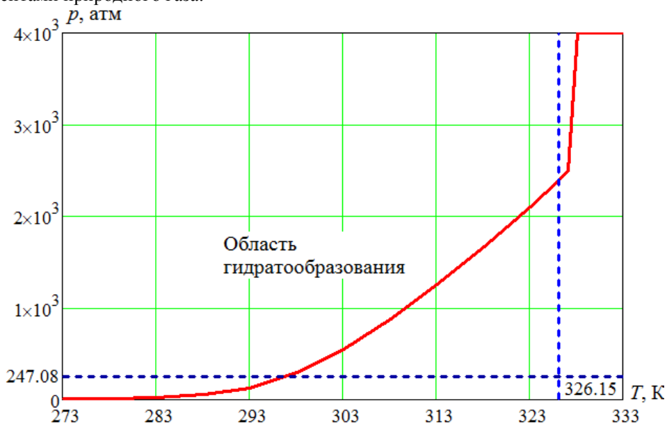
Рис. 2. Равновесные условия гидратообразования для природного газа Средневилюйского месторождения компонентного состава: \text{CH}_4 – 90,50; \text{C}_2\text{H}_6 – 4,69; \text{C}_3\text{H}_8 – 1,79; изо- \text{C}_4\text{H}_{10} – 0,55; \text{C}_5^+ – 1,54; \text{CO}_2 – 0,18; \text{N}_2 – 0,75. Сплошная линия соответствует равновесным условиям гидратообразования. Точка пересечения штриховых линий соответствует пластовому условию.
