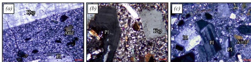
Рисунок 1. а) Сиенит-порфиры, увел 40, николи X; б) Пироксен-амфиболовые сиениты, увел 40, николи X; в) Монцонит-порфиры, увел 40, николи X. Условные обозначения: Ksp – калиево-полевой шпат, Pl – плагиоклаз, Amf – амфибол
