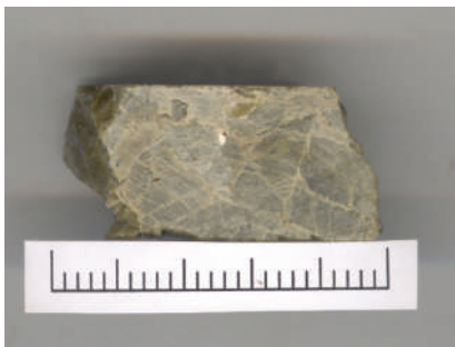
Рис. 4.2.17. Массивная текстура крупноблочного сидерита-1 (с-225 инт. 97,8)
